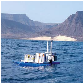
Der MarParCat, ein autonomer Katamaran, der durch rotierende Glasplatten den marinen Oberflächenfilm (SML) der Meere sammelt, im Einsatz bei der MarParCloud Kampagne. The MarParCat, an autonomous catamaran that samples the sea surface microlayer on rotating glass plates, in operation during the MarParCloud campaign. Photo: Nadja Triesch / TROPOS
