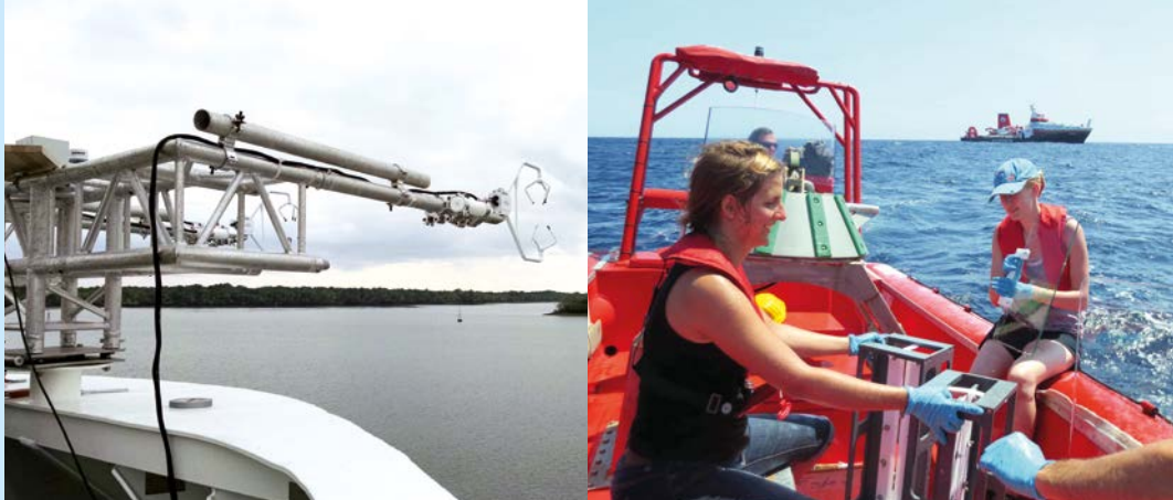
Links: Eddykovarianz-Turm am Schiffsbug zur direkten Messung der Emission mariner Spurengase, Rechts: Beprobung der Oberflächenmikroschicht (SML) des Ozeans mit einer Glasplatte, Unten: Start einer Radiosonde, die zur Untersuchung der Stabilität der atmosphärischen Grenzschicht verwendet wird. Left: Eddy-Covariance tower on ship's bow for direct air-sea flux determination of several trace gases, right: probing the surface microlayer (SML) of the ocean with a glass plate, bottom: launching a radiosonde, used to investigate the stability of the atmospheric boundary layer. Photos: GEOMAR, Sonja Endres / GEOMAR, Folkard Wittrock / IUP Bremen
