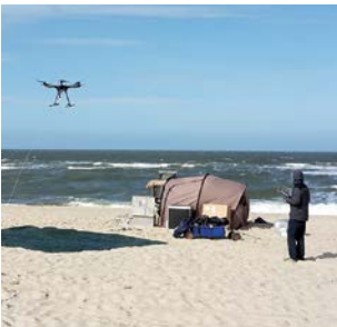
Drohnen, die mit Vorrichtungen für Probenahmen von Wasser und Luft ausgestattet sind, werden eine wichtige Rolle bei zukünftigen Untersuchungen des Ozean-Atmosphäre-Austausches von Spurengasen spielen. Drones, equipped with sampling devices for water and air, will play an important role in future investigations of the air-sea interactions between the anthropogenic and natural, terrestrial and oceanic processes. Photo: Christa Marandino / GEOMAR
