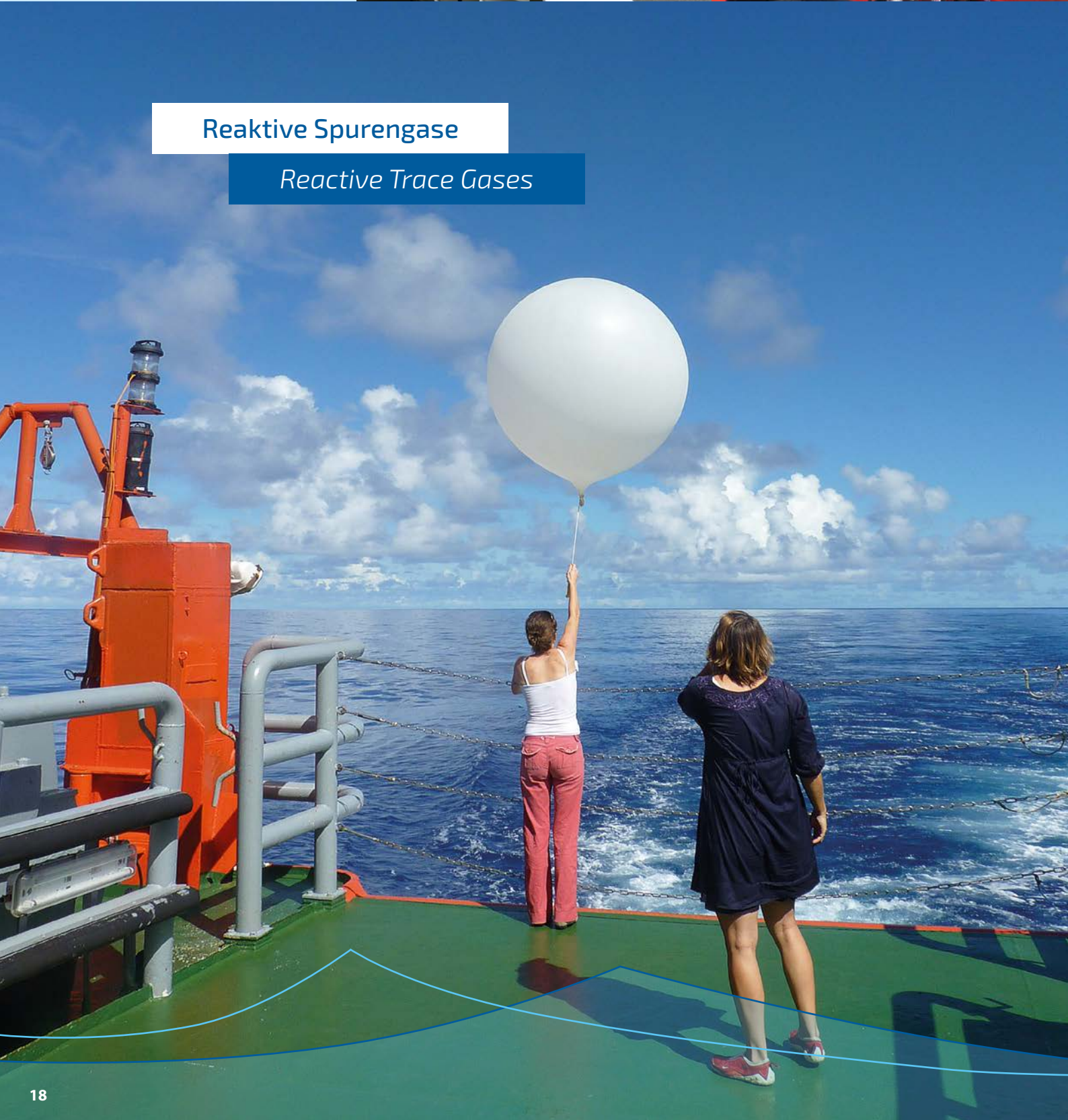
Links: Eddykovarianz-Turm am Schiffsbug zur direkten Messung der Emission mariner Spurengase, Rechts: Beprobung der Oberflächenmikroschicht (SML) des Ozeans mit einer Glasplatte, Unten: Start einer Radiosonde, die zur Untersuchung der Stabilität der atmosphärischen Grenzschicht verwendet wird. Left: Eddy-Covariance tower on ship's bow for direct air-sea flux determination of several trace gases, right: probing the surface microlayer (SML) of the ocean with a glass plate, bottom: launching a radiosonde, used to investigate the stability of the atmospheric boundary layer. Photos: GEOMAR, Sonja Endres / GEOMAR, Folkard Wittrock / IUP Bremen
