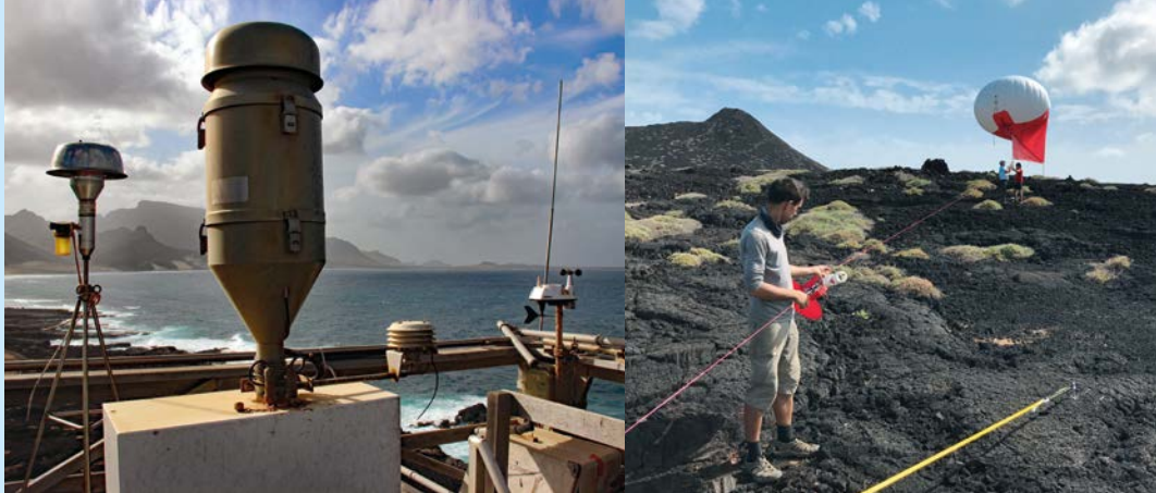
Links: Ein Filtersammler am CVAO, der ganzjährig Aerosolpartikel sammelt. Rechts: Ein Ballondrachen im Einsatz. Er misst Vertikalprofile von Temperatur, relativer Luftfeuchte und Druck bis zu einer Höhe von 1 km. Unten: CVAO bei Calhau, São Vicente. Left: A filter sampler at the CVAO, collecting aerosol particles all year round. Right: A balloon-kite in action. It measures vertical profiles of temperature, relative humidity and pressure up to a height of about 1 km. Bottom: CVAO near Calhau, São Vicente. Photos: Arne Körtzinger / GEOMAR, Frank Stratmann / TROPOS, Johannes Lampel / MPIC
